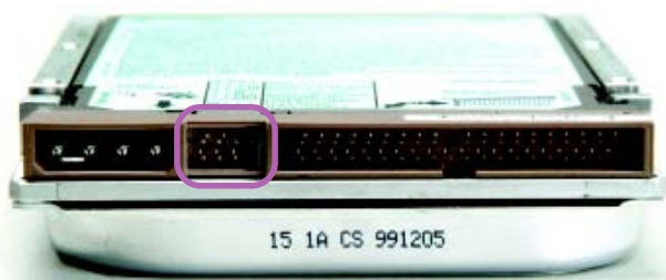
▲ 圖 3-77 IDE 介面之裝置 Jumper 設定
