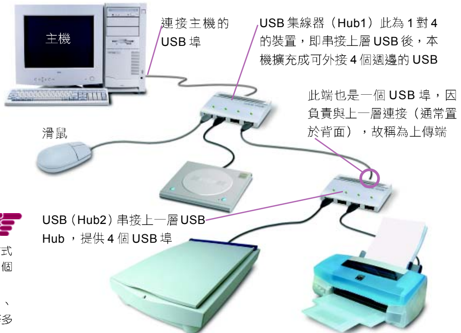
▲ 圖 3-3 USB Hub 連接多種週邊設備範例
