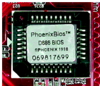
▲ 圖 3-12 主機板上的 BIOS (以 ROM 製成)
