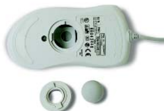
▲ 圖3-65 滑鼠、滑鼠底蓋及滾輪的分解
