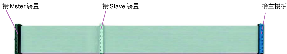
▲ 圖 3-76 Jumper 設定為 Cable Select 的裝置連接方式
