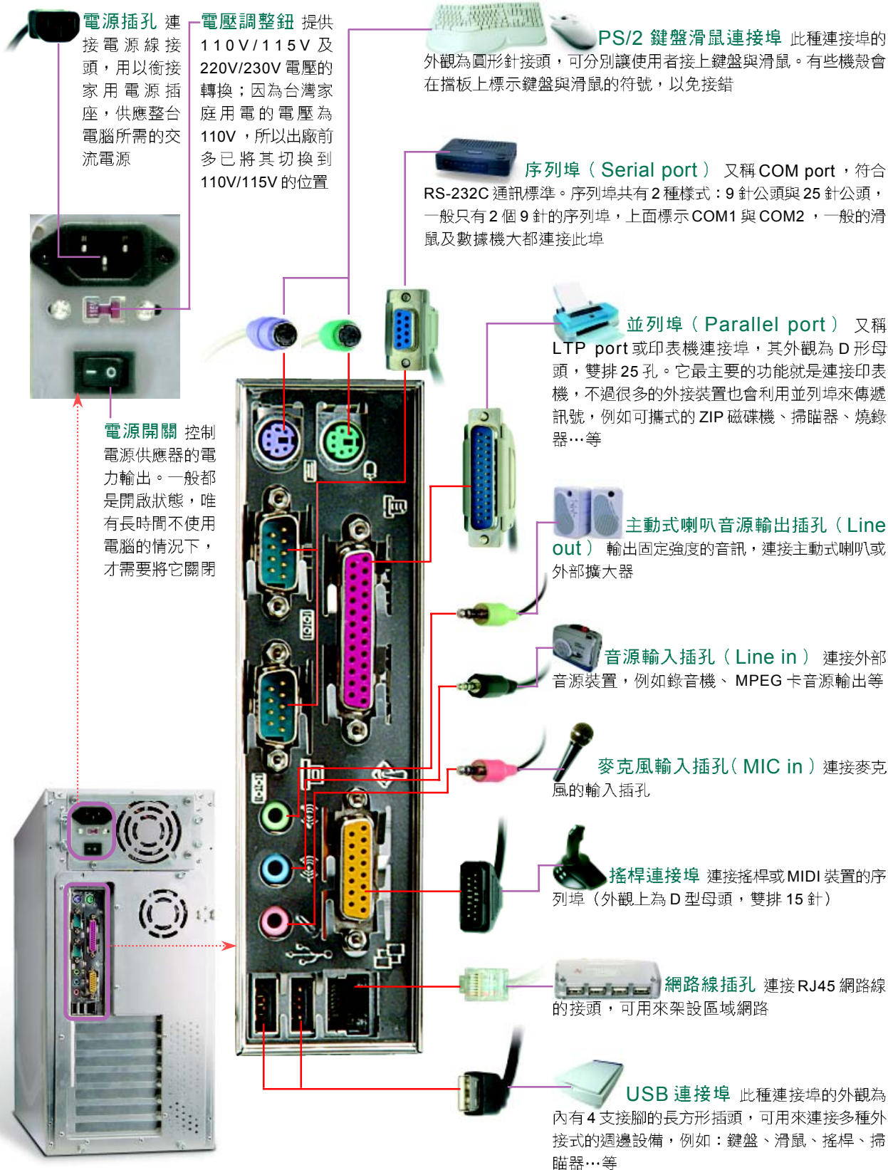
▲ 圖 3-2 個人電腦主機背面的接孔
