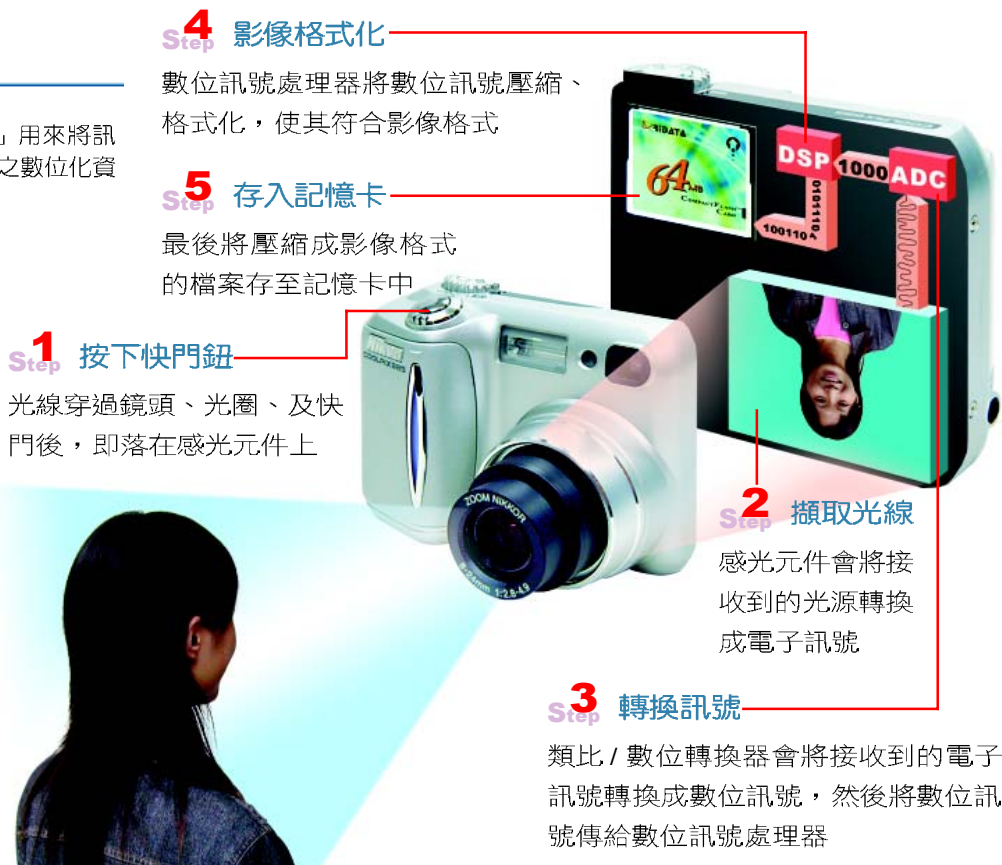
▲ 圖 3-32 數位相機的運作原理
