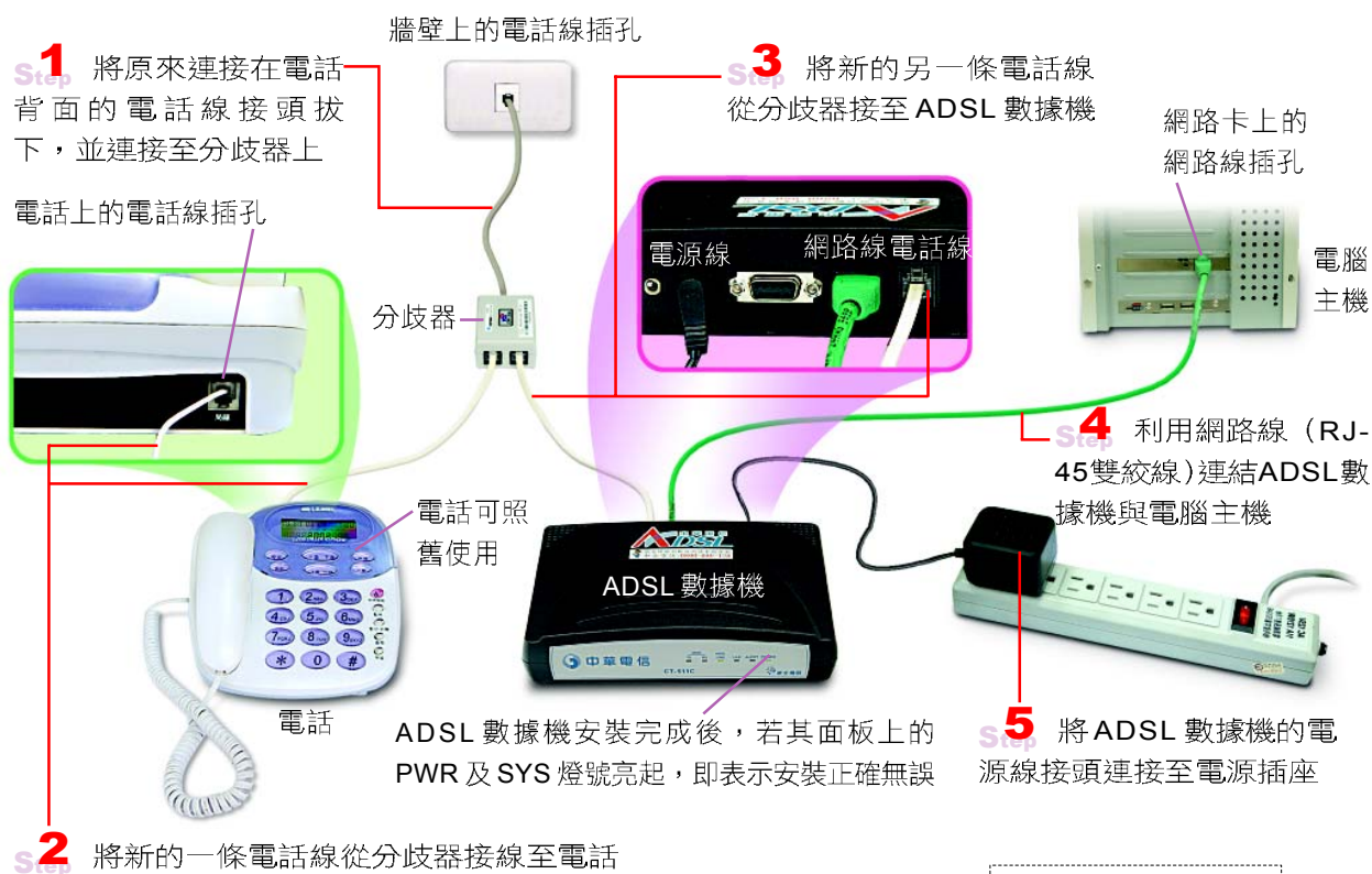
▲ 圖 7-47 單機使用 ADSL 寬頻上網的硬體安裝方法
