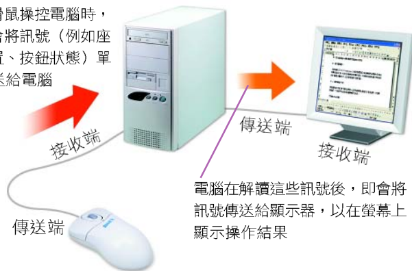
▲ 圖 7-1 滑鼠與顯示器都屬於單工傳輸
